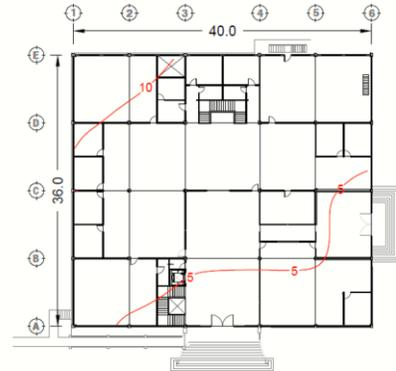
Fig. 2 Configuración topográfica con nivel de manguera en sótano
