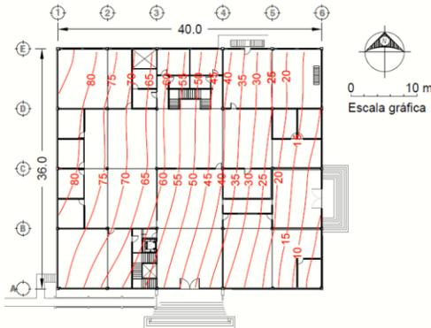
Fig. 1 Configuración topográfica con nivel de manguera en sótano
