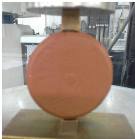
**Figura 3.** Ensayo de Resistencia a la tracción indirecta.
