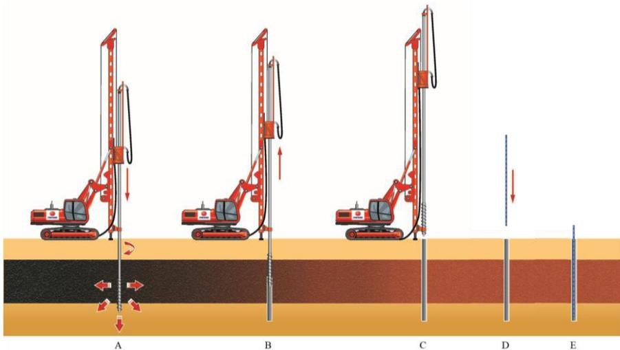
**Figura 1.** Secuencia constructiva general de una CMC reforzada. A) Perforación; B) Extracción de la barrena y colocación del concreto; C) Fin de colocación de concreto hasta la plataforma de trabajo; D) Instalación de armadura de acero de refuerzo E) Fin de construcción de CMC reforzada.
