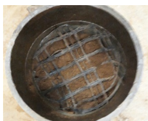
Figura 2. Posicionamento da geogrelha no cilindro.
