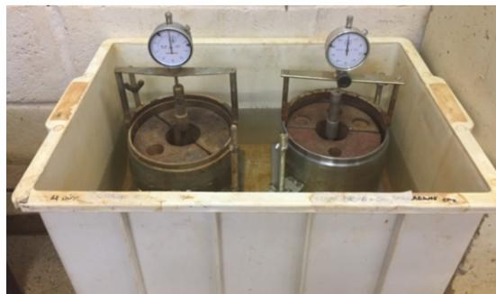
**Figura 2.** Cilindros submersos em água para execução do CBR.
