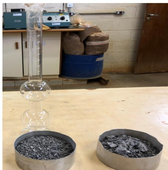
**Figura 3.** Amostras do Ensaio de Massa Específica pelo frasco de Chapman.
