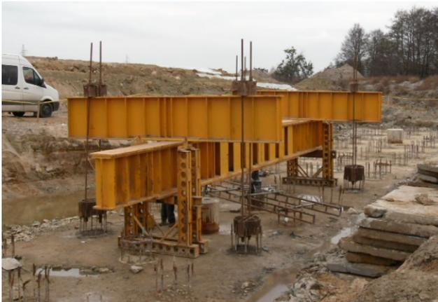
Figura 1. Ensayo de carga estática con gato instalado bajo vigas de lastre soldadas a 4 pilotes apartados.
