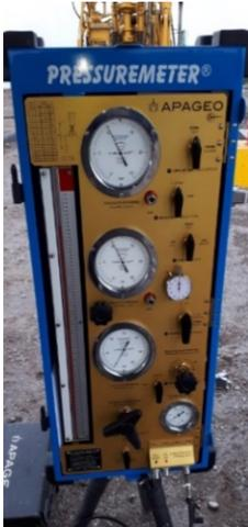
Figura 8 Unidad de control presión - volumen [12].
