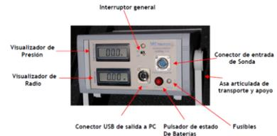
Figura 10 Unidad de control presión volumen [12].
