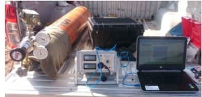
Figura 7 Unidad de Control para ensayos presiométricos con sonda Elastómetro HQ [12].
