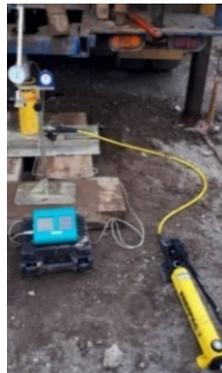
**Figura 4.** Sistema de aplicación de carga a extracción
