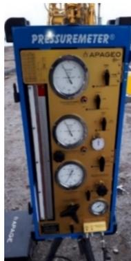
**Figura 3.** Unidad de control presión – volumen.
