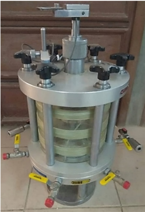
Figura 1. Edómetro de consolidación, marca Wykeham and Farrace.
