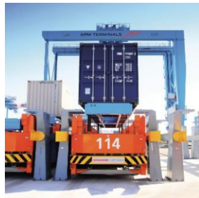
Figure 5. Lift AGV ( http://www.konecranes.de/ ).
