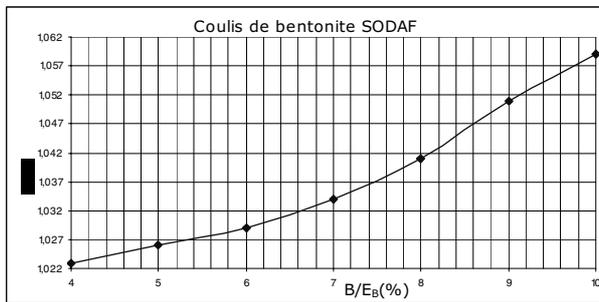
Fig 2 : variation de la densité en fonction de B/EB
