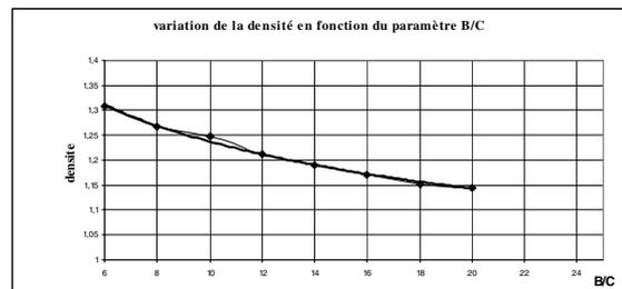
Fig 4 : densité en fonction de B/C : viscosité = 40 s
