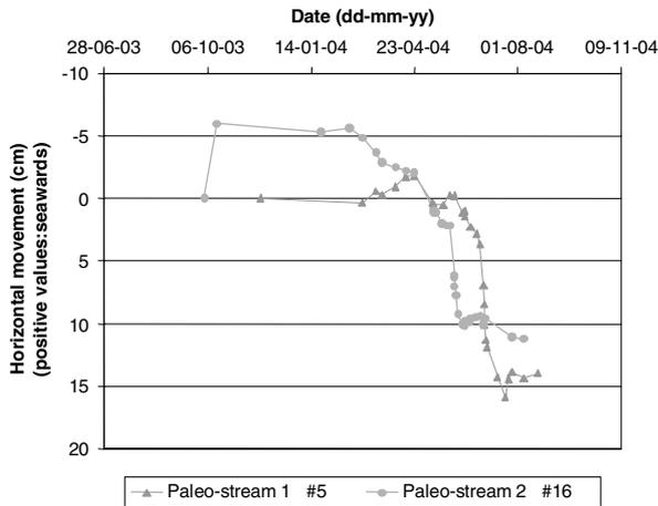
Figure 5.- Horizontal displacements at the Bajo de la Cabezueta quay
