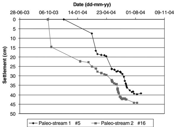
Figure 4.- Settlements at the Bajo de la Cabezueta quay
